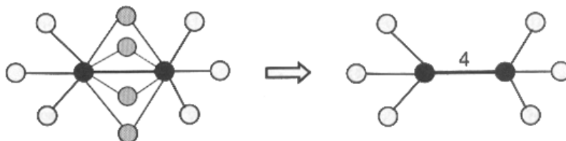
Фиг. 7-10. Изчисляване на SNN-сходство между две точки
