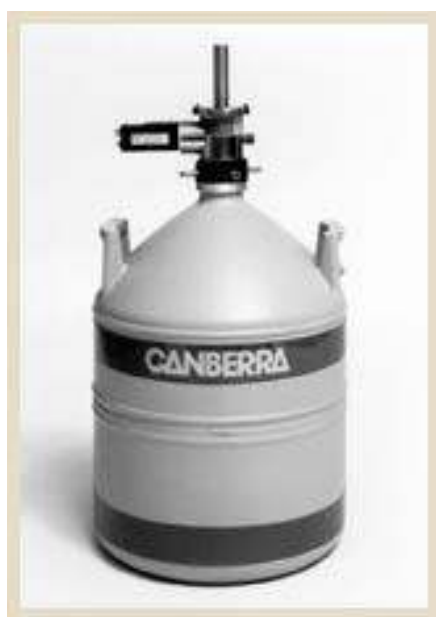
Външен вид и разрез на Ge(Li) детектор с криостат
