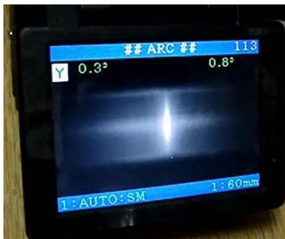
Фиг. У05-12. Заваряване – на екрана се вижда искрата
