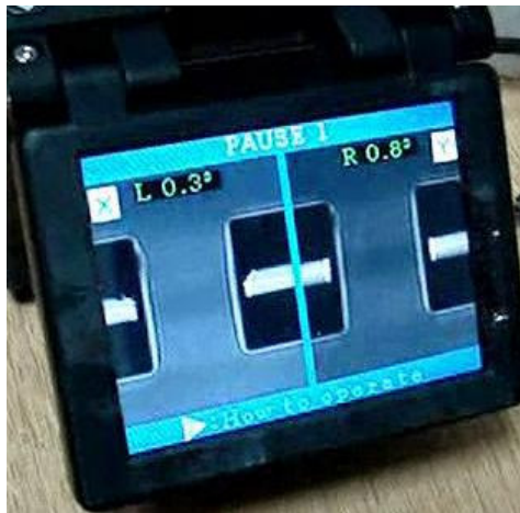
Фиг. У05-11. Процеса на подравняване се наблюдава на екрана
