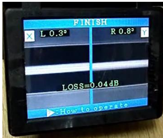
Фиг. У05-13. Тества се затихването на светлинния сигнал през сплайсването
