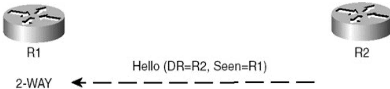
**2-way** състояние при установяване на двупосочни комуникации – начало на OSPF съседство. Избор на DR и BDR.
